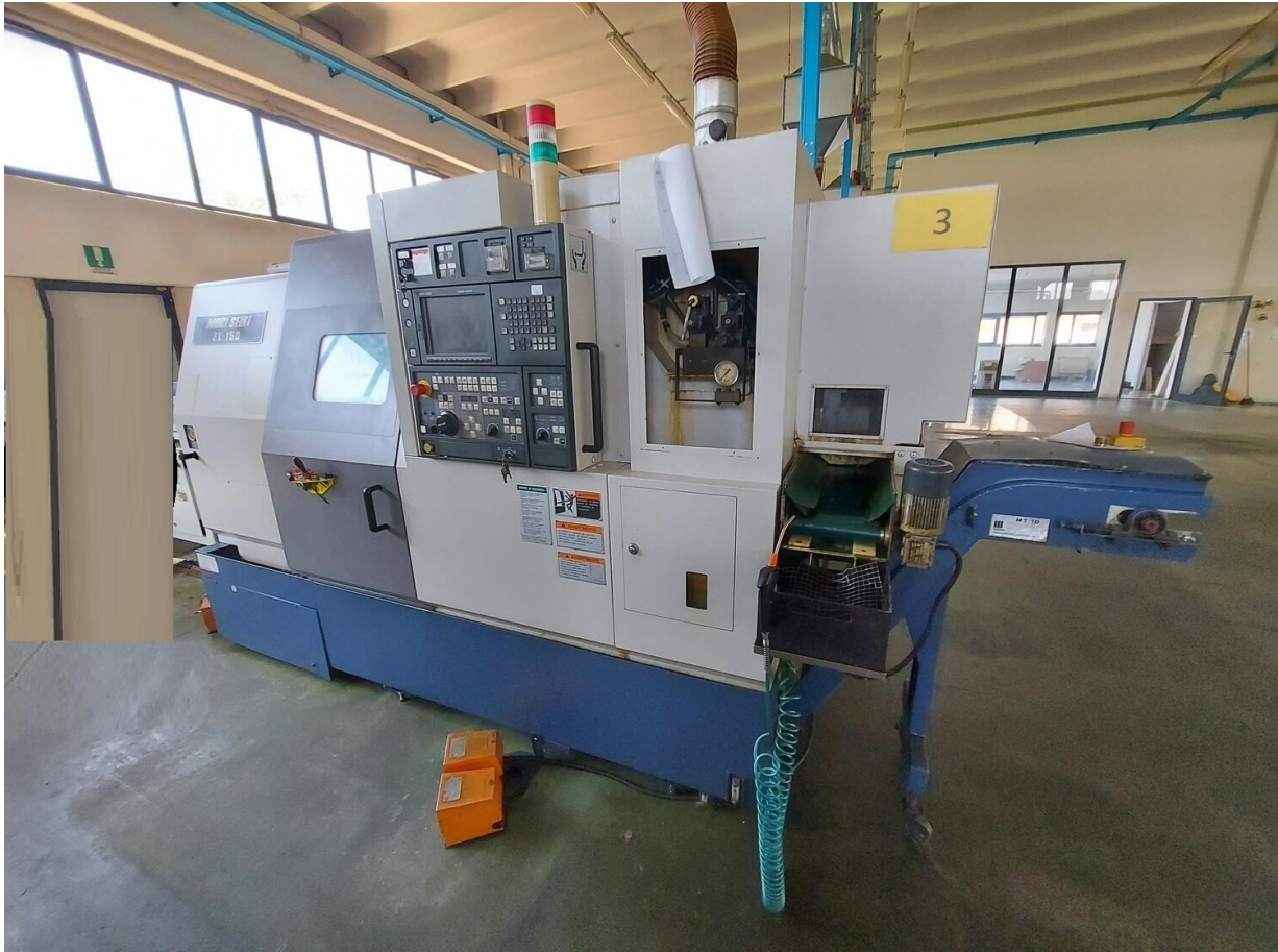
Vista frontale con evacuatore trucioli – Front view with chip conveyor – Vue frontale avec convoyeur à copeaux – Voreansicht mit Spaneförderer
