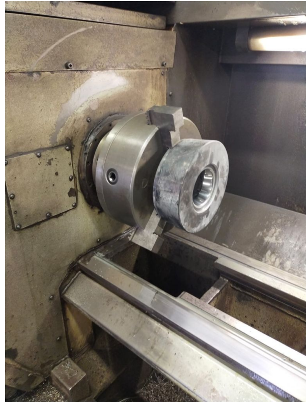
Torretta a 8 posizioni e autocentrante 270 mm – 8 station Tool turret and selfcentering chuck dia.270 mm - Tourelle porte-outils a 8 postes et mandrin diamètre 270 mm - 8 positionen Revolverkopf und Futter durchmesser 270 mm - Futter 270 mm
