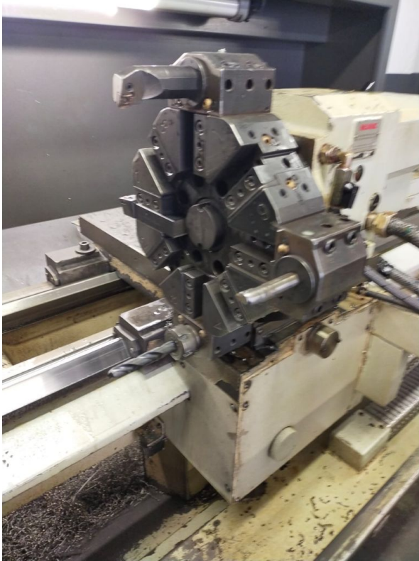
Torretta a 8 posizioni e autocentrante 270 mm – 8 station Tool turret and selfcentering chuck dia.270 mm - Tourelle porte-outils a 8 postes et mandrin diamètre 270 mm - 8 positionen Revolverkopf und Futter durchmesser 270 mm - Futter 270 mm
