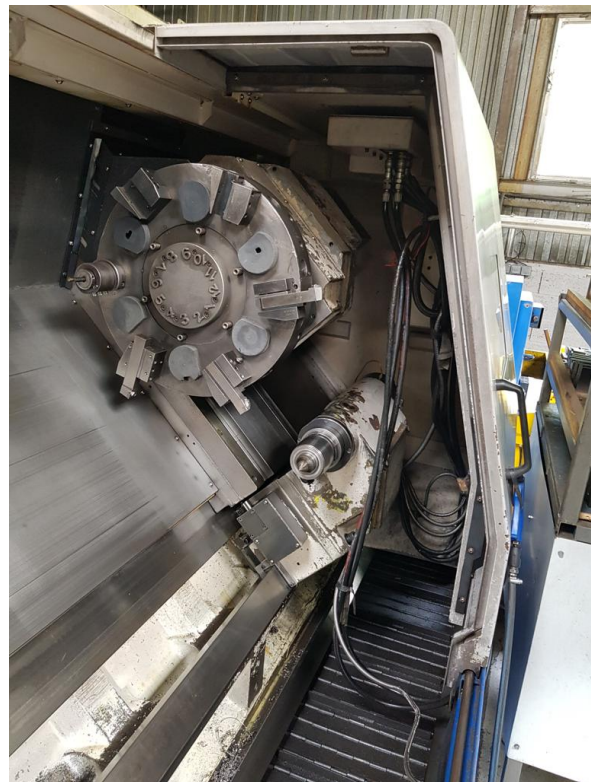
Autocentrante idraulico diametro 315 mm – Self centering chuck dia 315 mm – Mandrin fdiametre 315 – Hydraulische Spanefutter Durchmesser 315 mm
