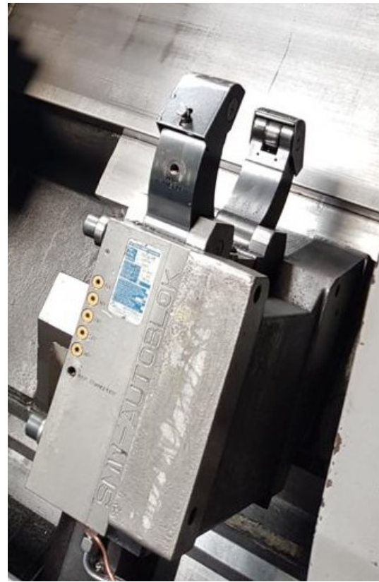
Evacuatore trucioli – Chip conveyor – Convoyeur à copeaux – Späneförderer Lunetta– Steady rest – Lunette – Lunette SMW AUTOBLOCK
