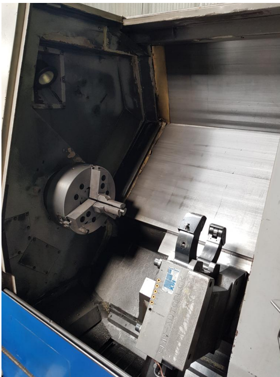
Autocentrante idraulico diametro 315 mm – Self centering chuck dia 315 mm – Mandrin fdiametre 315 – Hydraulische Spanefutter Durchmesser 315 mm
