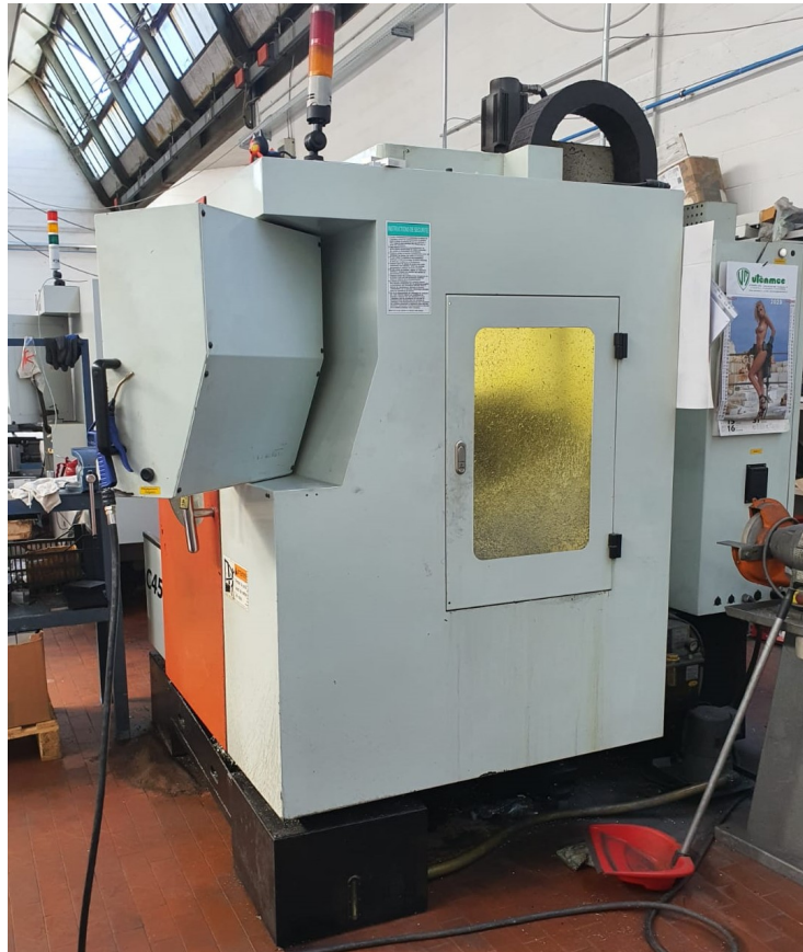
Velocità mandrino – Spindle speed - Vitesse de Broche - Spindeldrehzahl 8000 g/min BT 40
