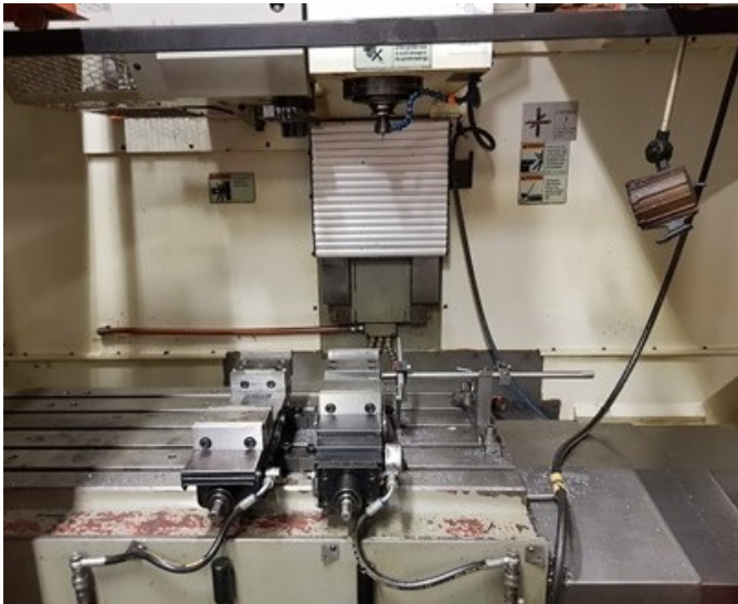
Velocità mandrino – Spindle speed - Vitesse de Broche - Spindeldrehzahl 6000 g/min BT 40
