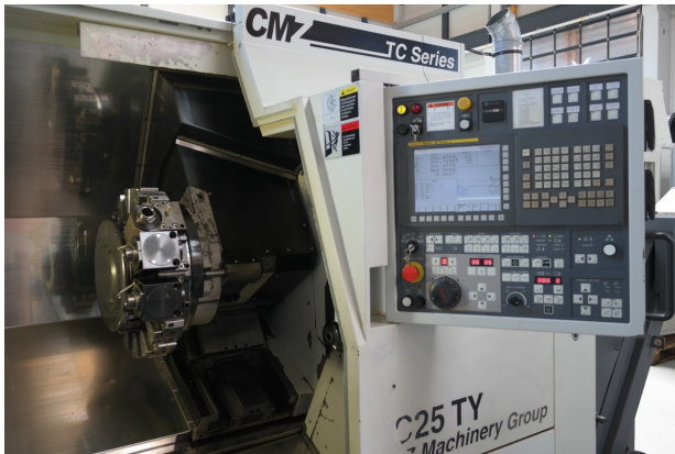
Torretta a 16 posizioni rotanti , Potenza 16 kW, con asse Y – 16 position Live tool turret with Y axis. Driven tool power 16 kW – Tourelle a 16 positions avec outils tournantes et axe Y . Puissance outils tournantes 16 kW – 16 positionen angetriebene werkzeuge Werkzeugrevolver. Angetriebene werkzeuge Leistung 16 kW
