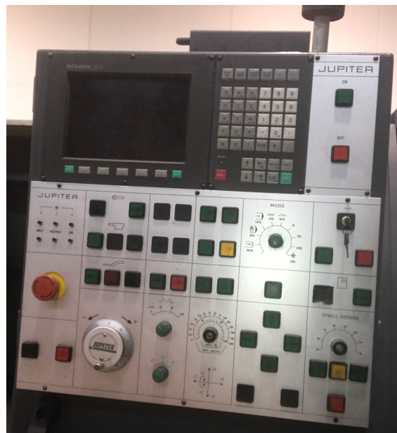
Unità di Governo MELDAS 520 – MELDAS 520 CNC unit – Commande Numérique MELDAS 520 - MELDAS 520 Steuerung
